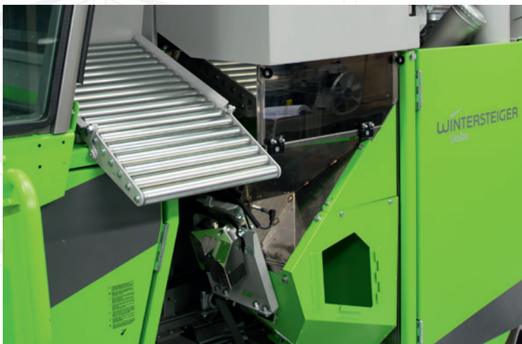
Die NIR-Systemlösung integriert sich perfekt in den Ablauf am Parzellenmähdrescher.
