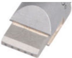
Rhomboid Diamant 5 x 0,6 x 0,6 mm, Gesamt-Tragfläche 1,80 mm 2 , r = 0,40 mm
