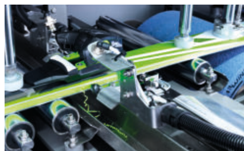
Trimcut - Pretrattamento automatizzato dei fianchi
