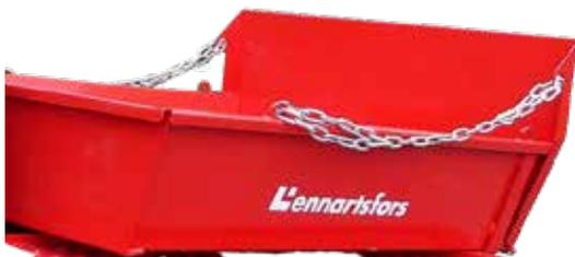
Die Plattform wird leicht auf dem Iron Horse montiert. Mit der abgesenkten großen Heckklappe ist es einfach, schwere Materialien vom Boden mit Hilfe der Winde zu laden.
